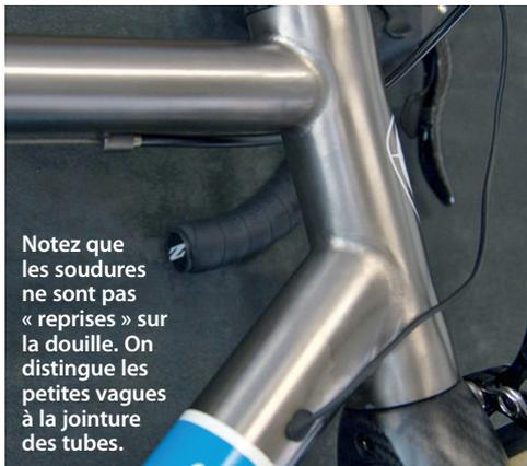
Notez que les soudures ne sont pas « reprises » sur la douille. On distingue les petites vagues à la jointure des tubes.
